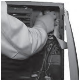
5. Insérer le fil conducteur dans le WiFi connecteur de la carte de principale circuit imprimé.
