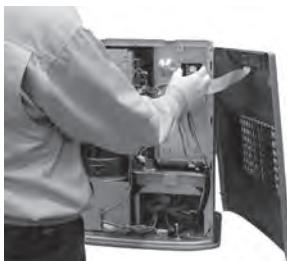
5. Entfernen Sie die beiden Schrauben an der hauptsächlich Leiterplatten-Klemme.
