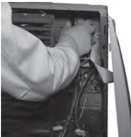
5. Inserte el terminal del cable en el conector WiFi de la placa del circuito principal.
