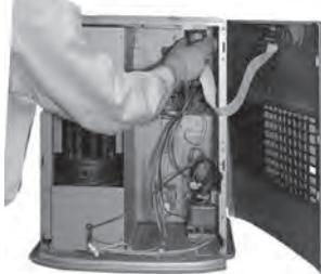
5. Führen Sie den Zuleitungsdraht in den WiFi Anschluss der hauptsächlich Leiterplatine.
