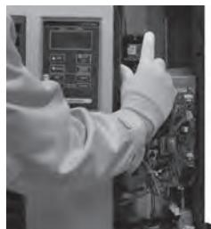
5. Insérer le fil conducteur dans le WiFi connecteur de la carte de principale circuit imprimé.
