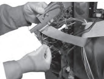
7. Instale la abrazadera de la placa del principal circuito.
