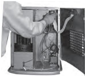
5. Plaats de kabel in de WiFi aansluiting van de hoofdprintplaat.
