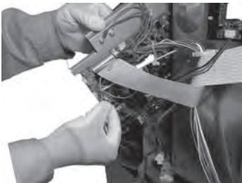
7. Installieren Sie die Hauptsächlich Leiterplatten-Klemme.
