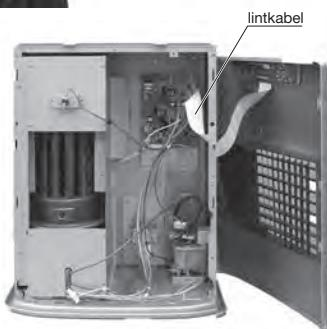
**OPMERKING:** Zorg ervoor dat u de lintkabel niet loskoppelt.
