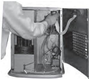
5. Inserte el terminal del cable en el conector WiFi de la placa del circuito principal.
