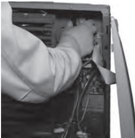
5. Führen Sie den Zuleitungsdraht in den WiFi Anschluss der hauptsächlich Leiterplatine.
