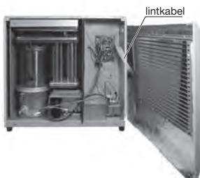
**OPMERKING:** Zorg ervoor dat u de lintkabel niet loskoppelt.
