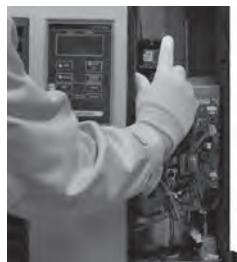
5. Inserte el terminal del cable en el conector WiFi de la placa del circuito principal.
