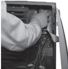
5. Plaats de kabel in de WiFi aansluiting van de hoofdprintplaat.
